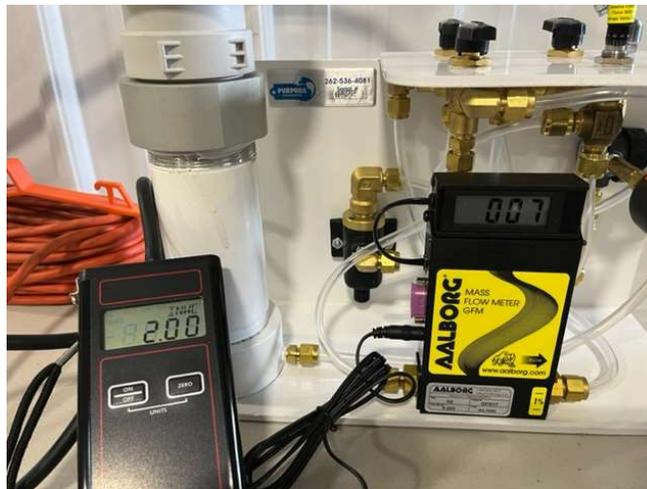
3. Registre el caudal en ml/min del caudalímetro digital
